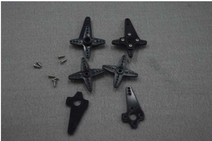
25.加长摇臂固定到舵臂上,建议不要用金属舵臂,容易伤舵机!
