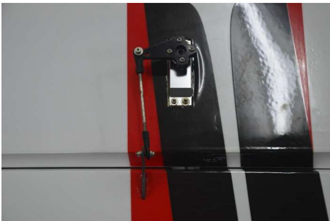
30.副翼舵机推杆安装效果图
