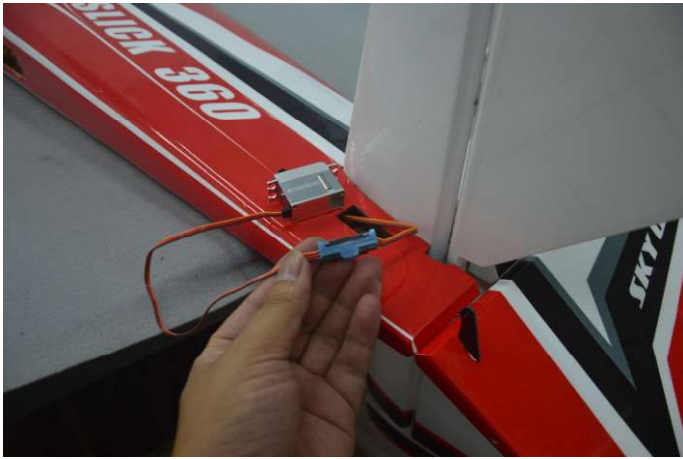
23.尾翼舵机安装
