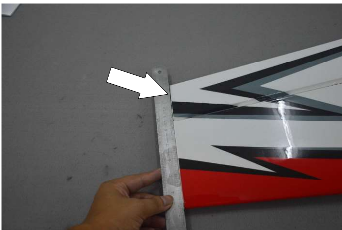
4.副翼粘接时要考虑副翼尖和机翼尖保留1MM距离，然后固定副翼
