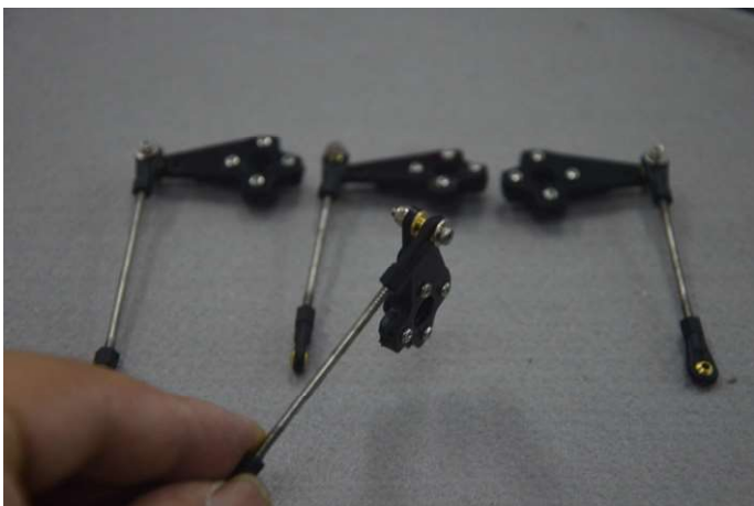
26.注意带垫的球头是锁摆臂上的,固定螺丝也区分长短.
