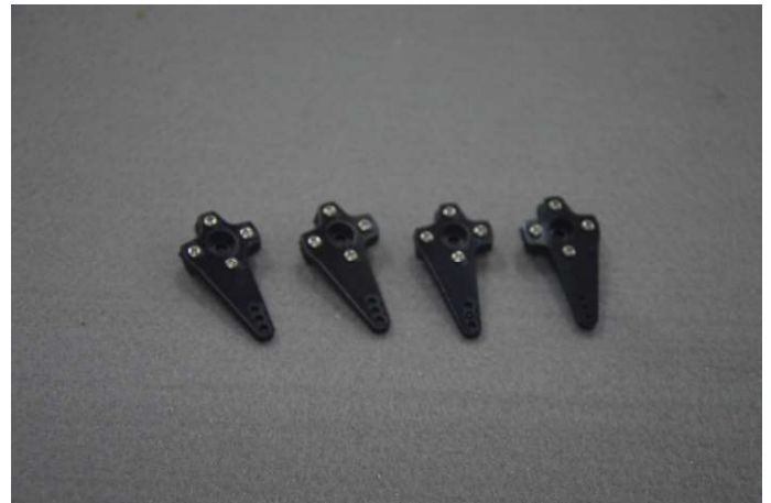
25.加长摇臂固定到舵臂上,建议不要用金属舵臂,容易伤舵机!
