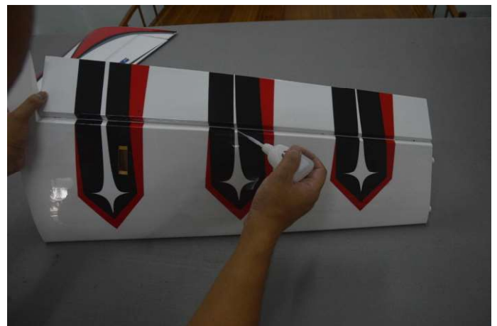
4.副翼粘接时要考虑副翼尖和机翼尖保留1MM距离，然后固定副翼
