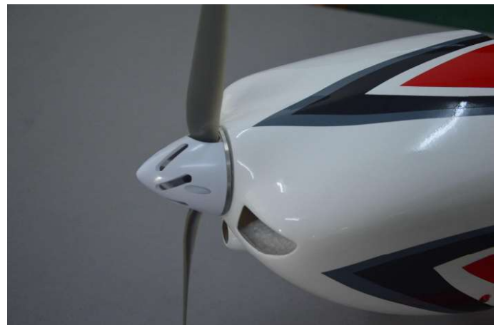
31.通电确认电机转动时没有反转后，就把整流罩和桨固定好。
