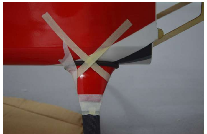
14.胶粘纸定位,防止胶水在没干透时移位
